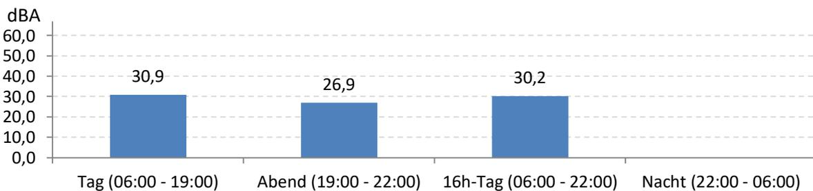
Abb. 9: LEQ bei Pistenbetriebsrichtung "östliche Winde"
